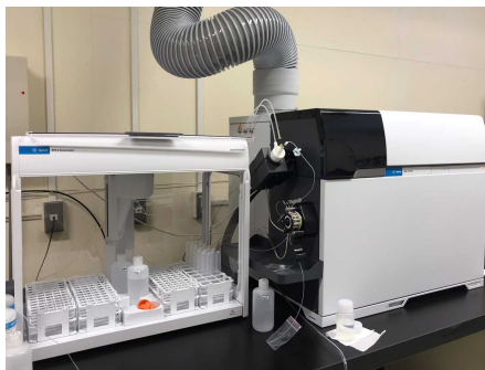
誘導結合プラズマ質量分析計 (カドミウムなどの金属類を検査します)
