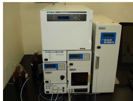
液体クロマトグラフ分析計 (洗剤の成分を検査します)
