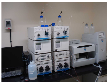
イオンクロマトグラフポストカラム分析計 (シアン及び亜硝酸を検査します)
